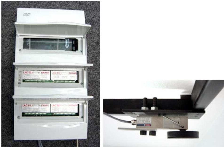
Steuereinheit für die Wägeplattform, Scherwägezelle
